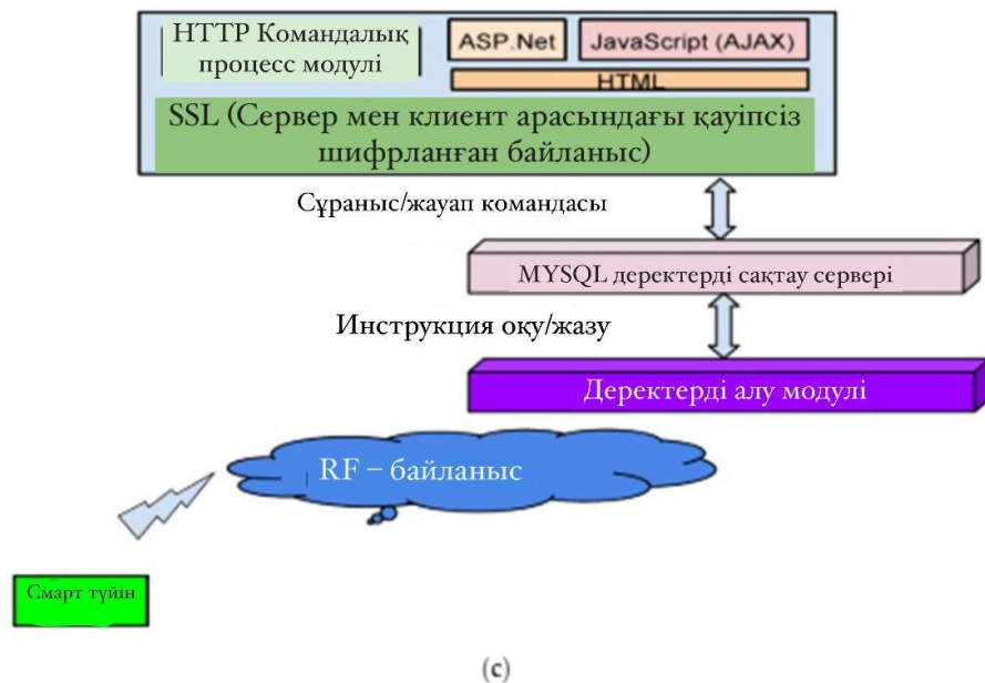
3.3-сурет – Жүйенің егжей-тегжейлі жұмыс процесі. (с) заттар интернеті (IoT) негізіндегі smart h үшін ұрлыққа қарсы жүйенің қабатты архитектурасы
